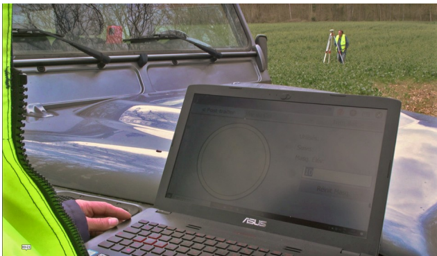
Figure n°14 : Antenne GNSS en statique, les données qui en découlent vont servir de base au référencement du nuage de points calculé.
