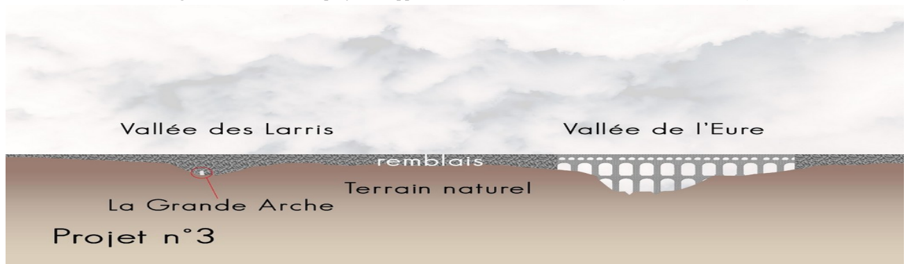
Figure n°10 : Le troisième projet : cette fois la vallée des Larris est traversée par un remblai de terre et oblige à la construction de la Grande Arche pour laisser s'écouler les "eaux sauvages". (PAO : Buchaille I.).
